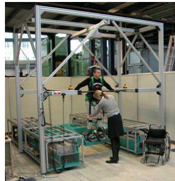
Abb. 1. Patient auf dem Gangrehabilitationsroboter Haptic Walker .
