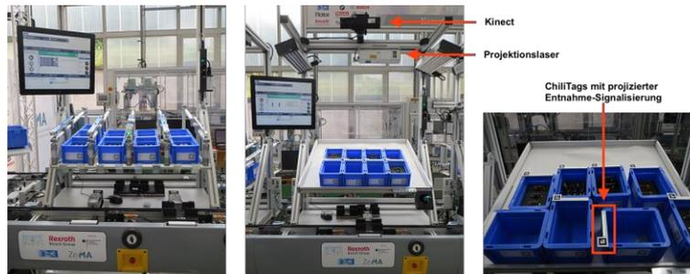
Abb. 1: Klassisches (links) und adaptives Pick-by-Light-System (Mitte, rechts)
