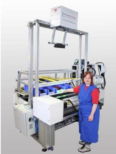
Abbildung 1: Einzelarbeitsplatz mit Assistenzsystem zur Montage von Schraubzwingen
