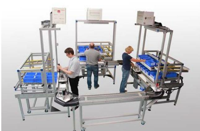
Abbildung 2: Assistenzsysteme in einer Montagezelle
