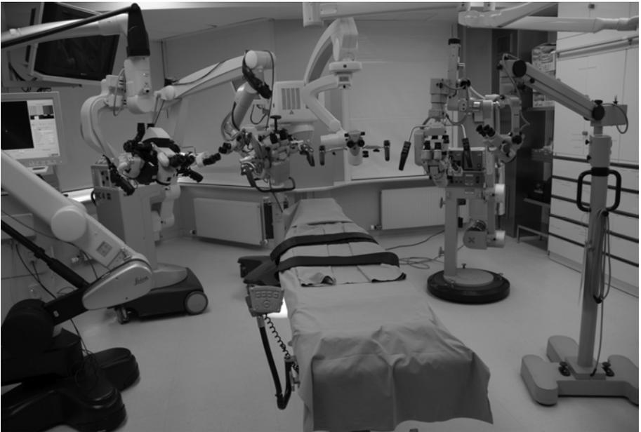
**Abbildung 1:** Übersicht der für die Messung verwendeten Mikroskope. Von links beginnend das Leica OL 5, Zeiss NC4, NC 31, Opmi Vario3 700 und S21.
