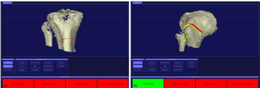
**Abbildung 2:** Planung der Schneidbahn. a) Manuelle Positionierung und Größenanpassung des Kreissegments entlang dem der Schnitt erfolgen wird relativ zum Knochenmodell. b) Die aus diesem Plan generierten Stützstellen der Roboterbahn entlang der Knochenoberfläche.
