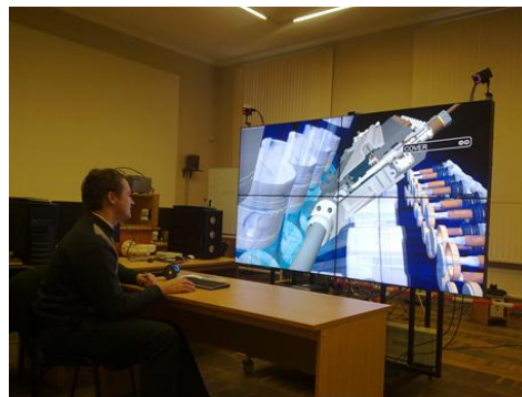
Иллюстрация интерактивного анализа модели дизеля с использованием видеостены 4 LCD NEC 46" UN и оптической системой трекинга TrackPack2
