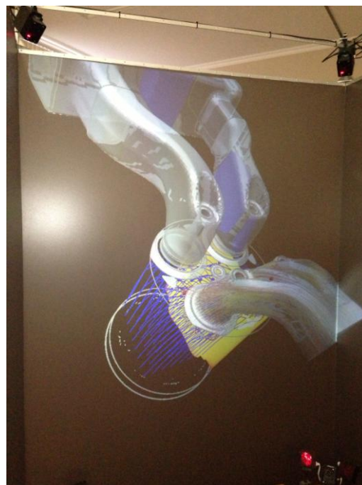
Анализ AVL результатов CFD моделирования в цилиндре дизеля средствами программно-аппаратного комплекса 3-sided CAVE 3D
