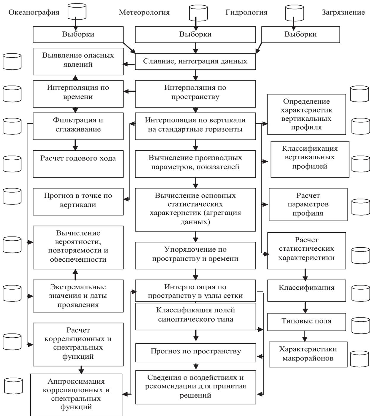
Рис. 1. Обобщенная блок-схема комплексной обработки гидрометеорологических данных [4]
