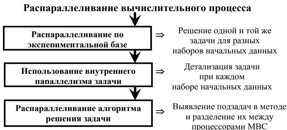
**Рис.1.** Трехуровневая модель распараллеливания вычислительного процесса при решении обратной задачи
