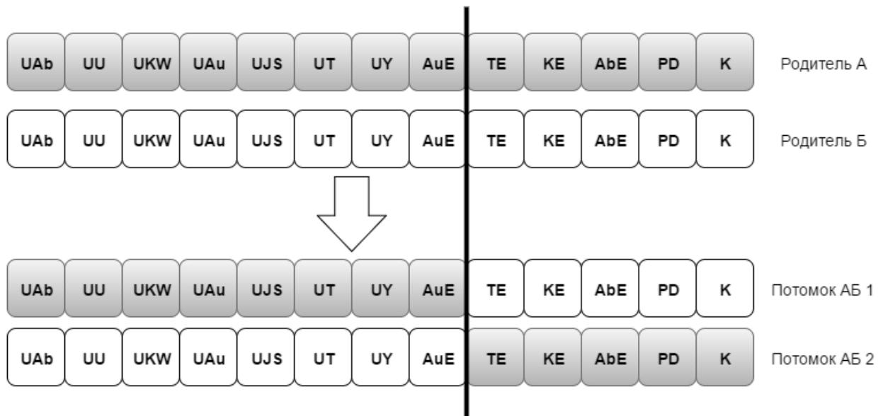
Рис. 4. Скрещивание хромосом
