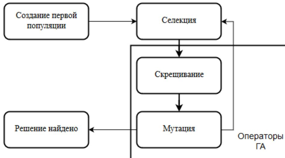
Рис. 2. Схема генетического алгоритма
