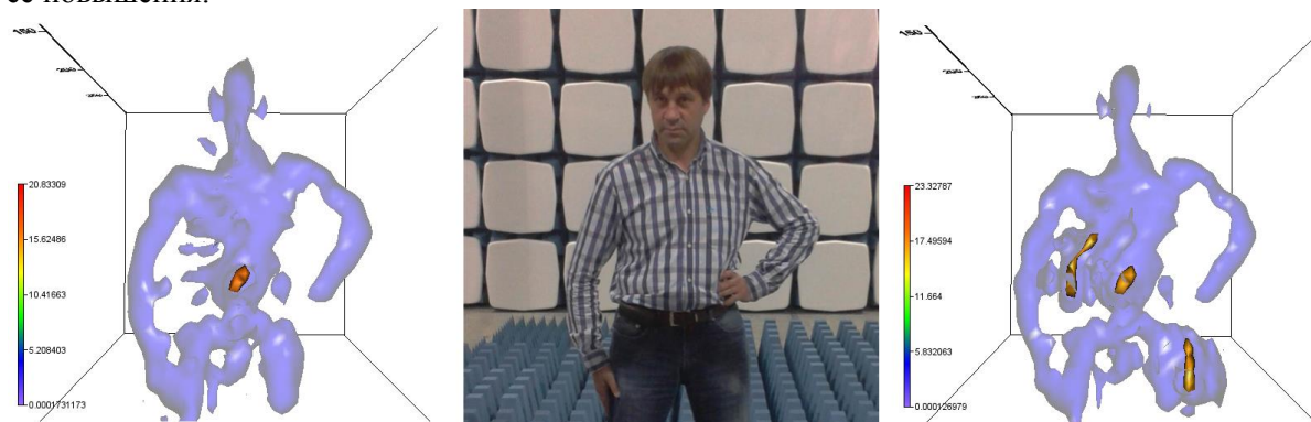
Рис. 1. Фотография (в центре) и трехмерные радиочастотные изображения человека без предметов (слева) и со скрытыми предметами (справа).
