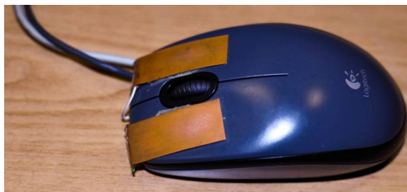
Fig. 4. Modified manipulator «mouse» layout to record GSR
