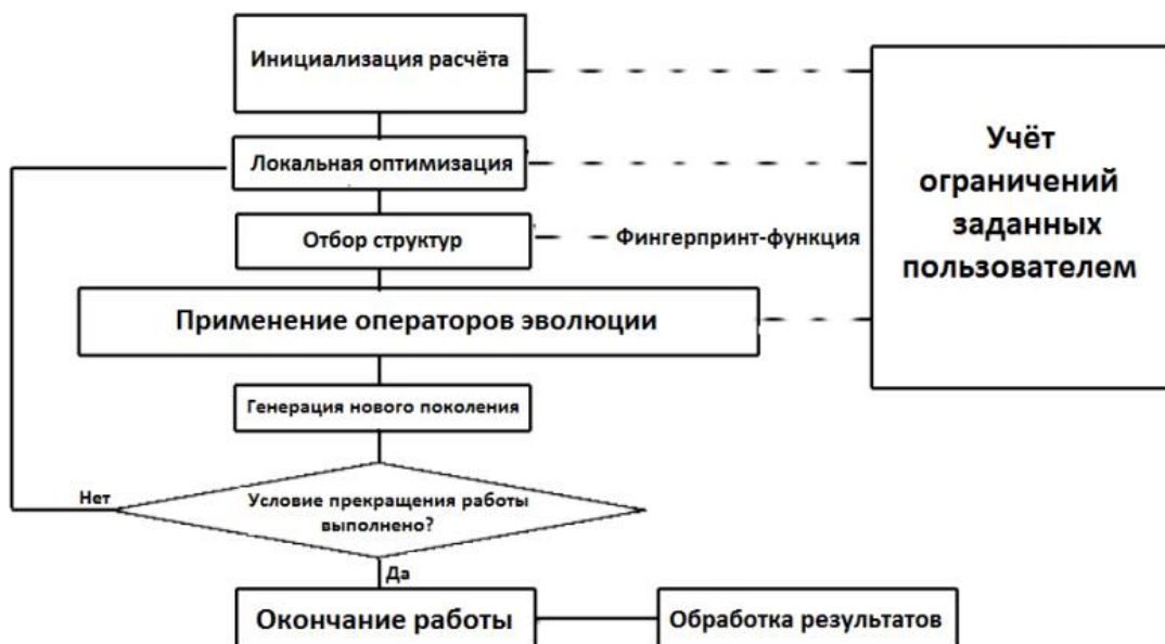
Рис.1. Схема работы алгоритма USPEX
