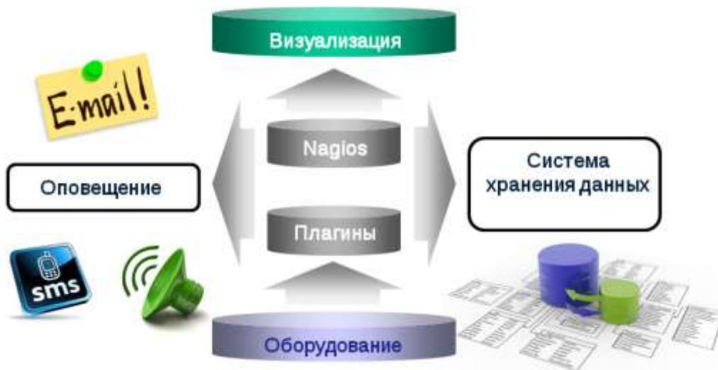
Рис. 1. Логическая схема системы мониторинга
