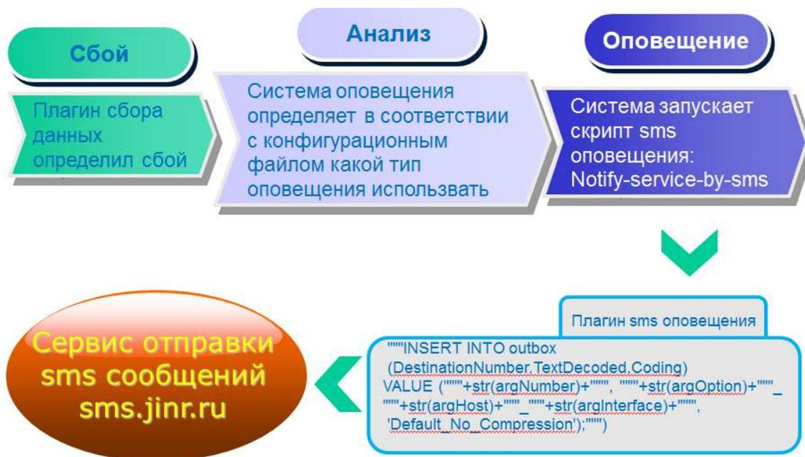
Рис. 3. Алгоритм работы SMS оповещения
