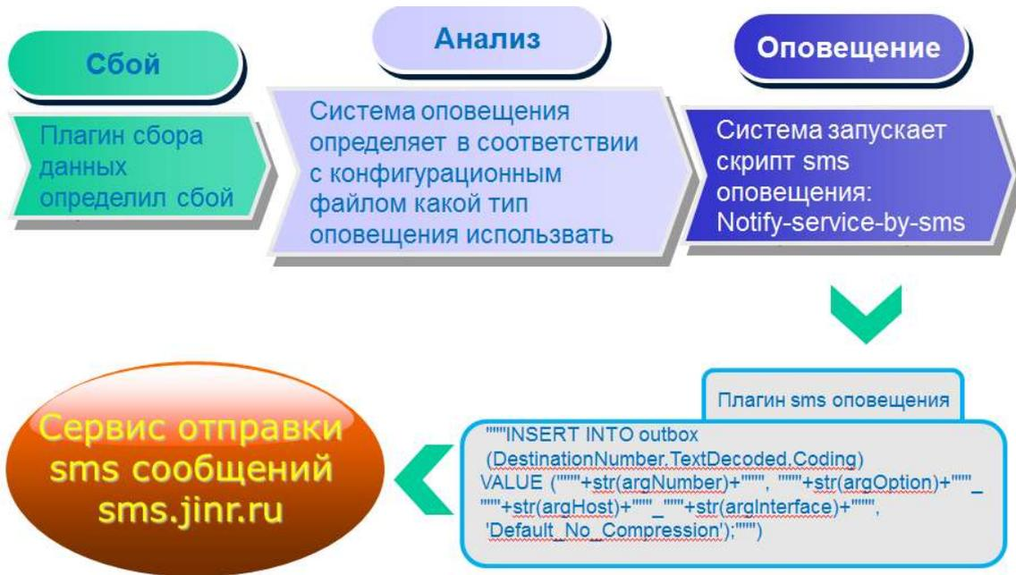
Рис. 3. Алгоритм работы SMS оповещения
