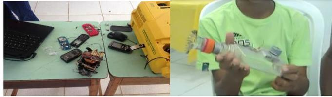
**Figura 3:Barco feito com garrafa PET, motor de DVD e bateria, utilizando o conceito e-waste.**
