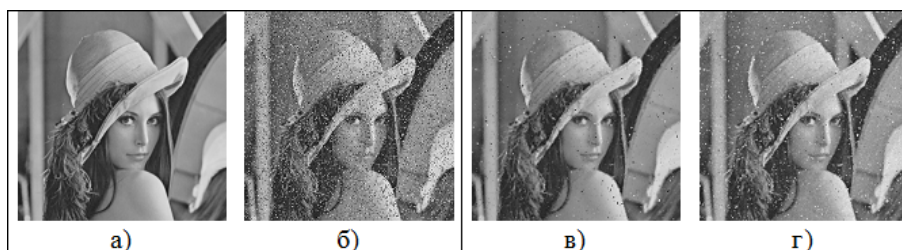
Рис. 4: Результаты применения фильтра к изображению «Лена» с уровнем шума p = 20\% : а) исходное изображение, б) зашумленное изображение, в) изображение, восстановленное предложенным фильтром, г) изображение, восстановленное медианным фильтром
