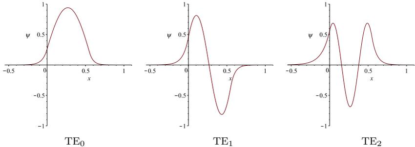
Рис. 3. График поперечных частей волноводных мод
