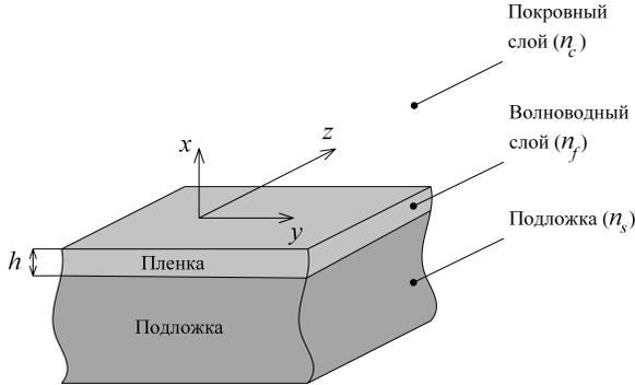
Рис. 1. Схема плоского трехслойного диэлектрического волновода
