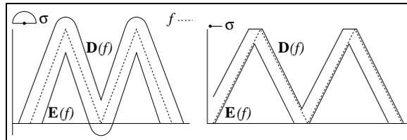
**Abb. 1.** Zwei Beispiele für grauwertige Erosion  $\mathbf{E}$  und Dilatation  $\mathbf{D}$  des Signals  $f$  mit dem Strukturelement  $\sigma$ .
