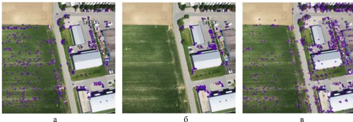
Рис. 2. Нахождение особых точек: а) алгоритм FAST, б) алгоритм FAST-ER, в) алгоритм SURF.
