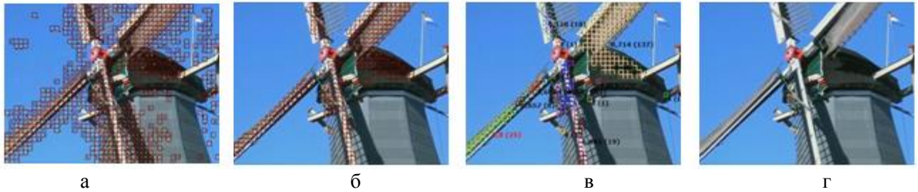
Рис. 4. Этапы выделения дыма по видеопоследовательности без дыма Dyntex/648ab10 [15] (кадр 1) с параметрами алгоритма: Blk=8 , T=20 , Rate=1 : а) все движение в кадре, б) серое движение в кадре, в) расчет турбулентности, г) результат работы алгоритма.
