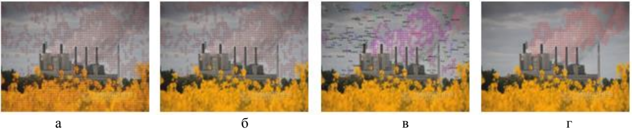
Рис. 3. Этапы выделения дальнего дыма по видеопоследовательности Youtube/Factory_13 [14] (кадр 2274) с параметрами алгоритма: Blk = 15 , T = 25 , Rate = 3 : а) все движение в кадре, б) серое движение в кадре, в) расчет турбулентности, г) результат работы алгоритма.
