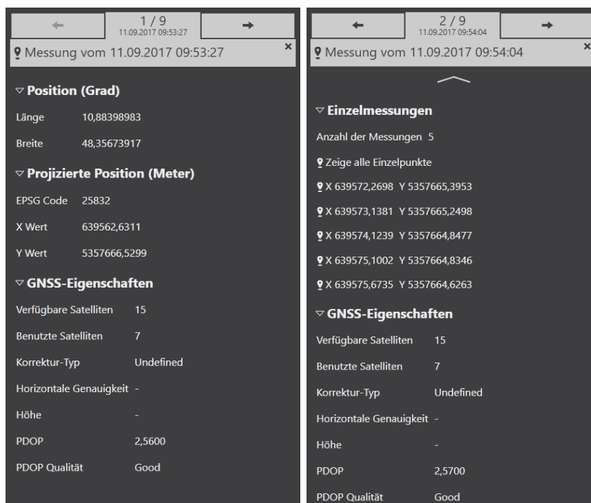
Abbildung 2: Beispiel Info-Center in GI Mobil RT (links für GNSS-Einzelmessung, rechts für GNSS-Mittelwertbildung)
