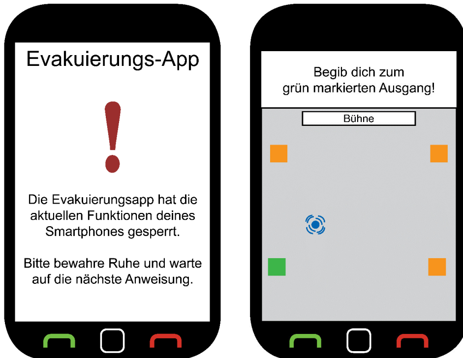
Abbildung 1: Nutzeransicht: Sperrung des Smartphones durch die Anwendung (links). Der nächstgelegene Ausgang wird grün markiert, die Position des Nutzers blau (rechts).
