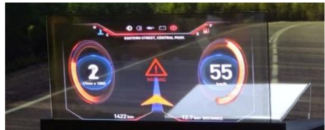
Fig. 2. Transparentes OLED mit der Möglichkeit zur optischen Überwachung des Displayinhaltes von der Panel-Rückseite
