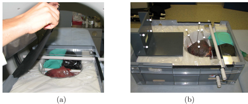
Abb. 3. Befestigung der Neopren-Haut am Simulator (a) und Referenztool (grau) zur Bestimmung der Bewegung einer Leber entlang der Achsen des Simulator-Koordinatensystems (b)
