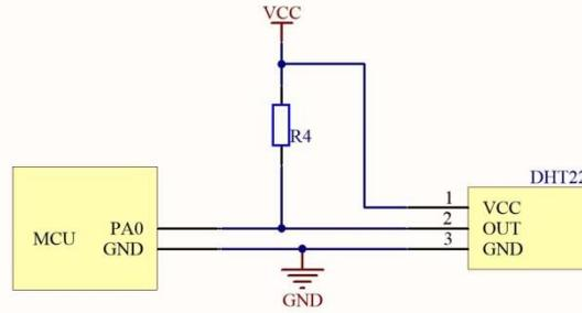
**Figure 3:** DHT22 sensor interface diagram
