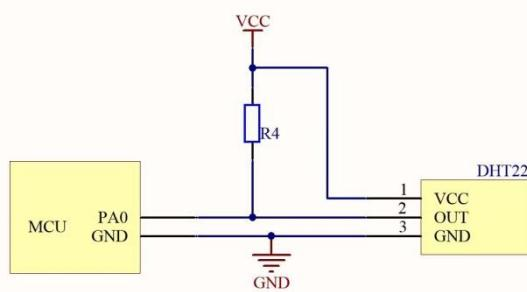
**Figure 3:** DHT22 sensor interface diagram
