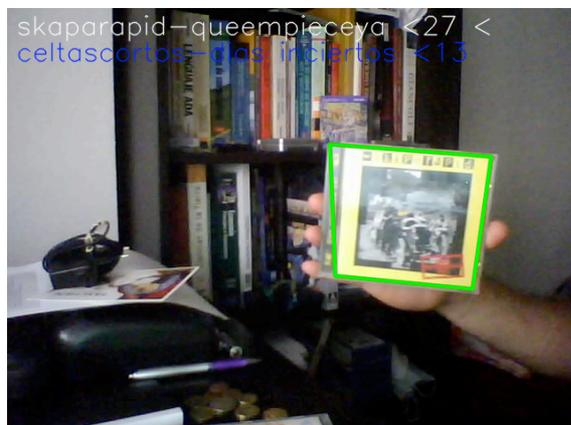
**Figura 3.** Ejemplo de preprocesado con un porcentaje de acierto del 27% para la imagen preprocesada.
