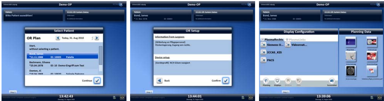
Abbildung 3: Präsentation der Planungsdaten an der zentralen Steuerkonsole im integrierten OP-System. Links: Anzeige aller geplanten Patienten am Tag, Mitte: Nachrichten des Chirurgen an die OP-Vorbereitung, Rechts: Zugriff auf alle Daten aus MetaPlan (Screenshots, Notizen, ..) sowie die Kontrollfunktionen des Videorouting-Systems.
