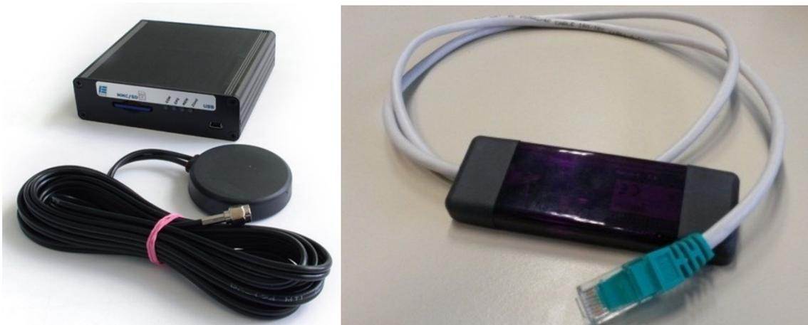
Abbildung 4: GPS-Datenlogger und Bluetooth-Datenübertragungsmodul
