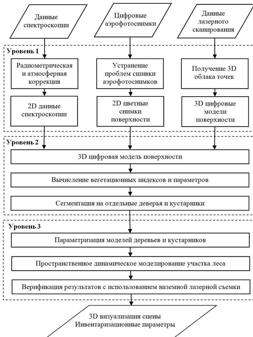
Рис. 2. Схема объединения данных от различных устройств.
