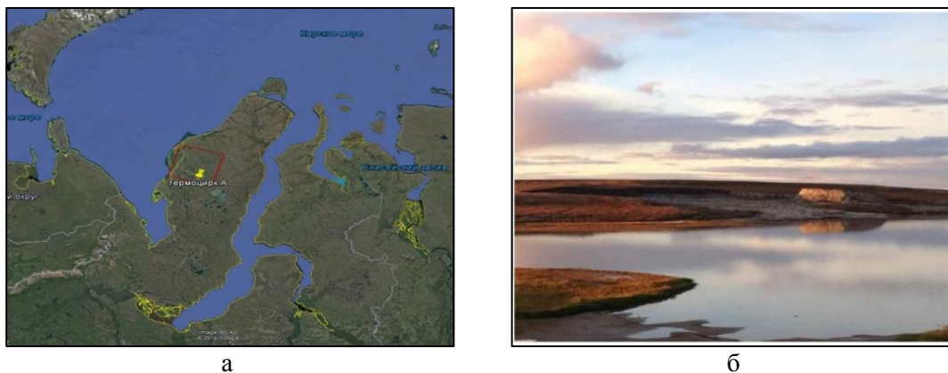
Рис. 1. а – расположение подспутникового полигона в центральной части п-ва Ямал; б – активный термоцирк, сформировавшийся и растущий в береговой зоне озера.
