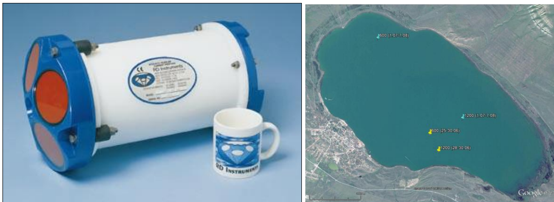
Рис. 1. Профилограф ADCP, расположение двух профилографов (ADCP-600 и ADCP-1200) в июне и в июле-августе 2015 г. в озере Шира.
