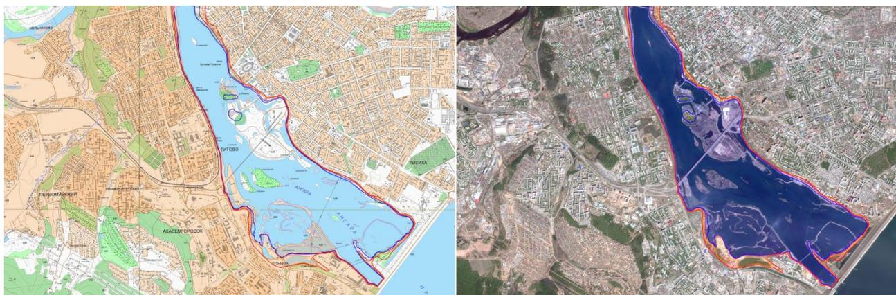
Рис. 3. Пример визуализации зон затопления при различных расходах Иркутской ГЭС.
