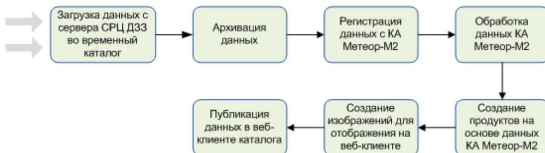
Рис. 2. Схема обработки полученных спутниковых данных.
