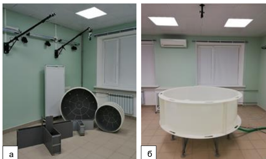
Рис.1. Тестовые установки: а-«Открытое поле» и Т-лабиринт (для мышей и крыс); б- Водный лабиринт Морриса
